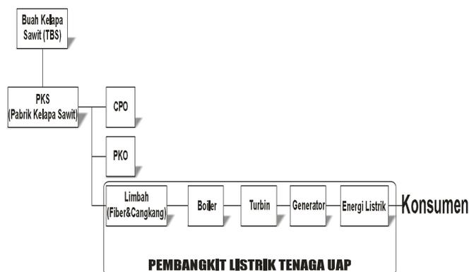
Gambar 3. Skema Proses Terjadinya Bahan Bakar PLTU 6 MW
